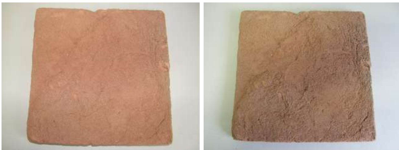
Slika 1: Makro posnetek sintranih plošč iz obeh strani.
