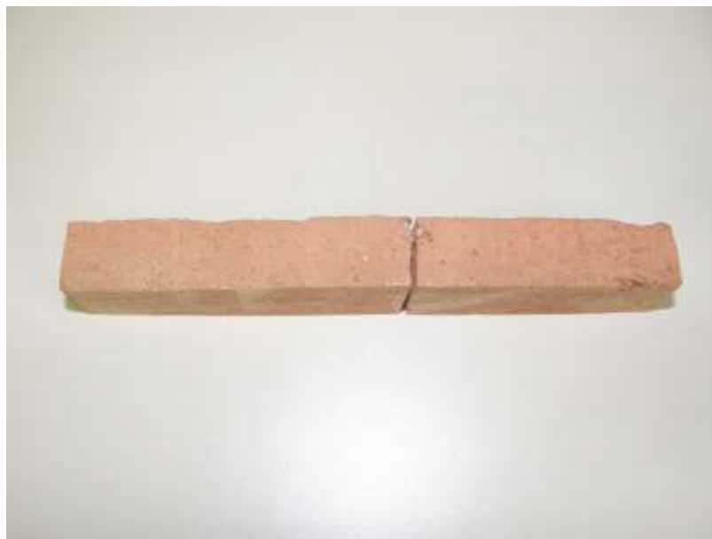
Slika 3: Skica upogibnega preizkusa sintrane gline in vzorca po izvedeni poružitvi.
